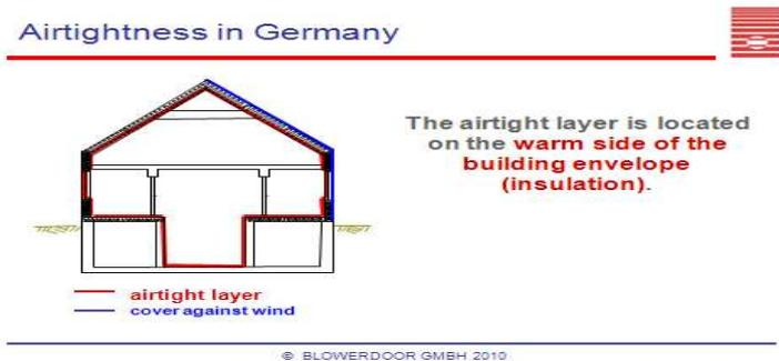
그림4 외피의 내부 기밀면이 끊어지지 않게 설계 및 시공
